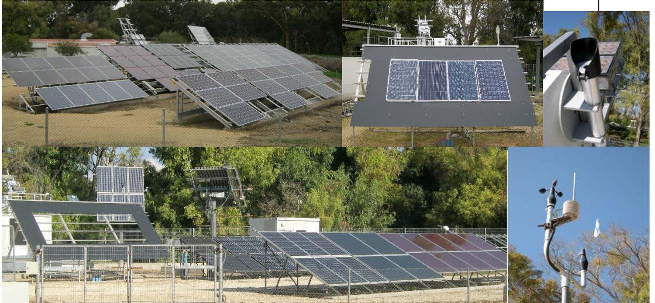
**기술적 세부사항:** 태양광시스템의 성능과 일반 기상 조건들이 IEC 61724 에 따라 최첨단 측정 플랫폼의 사용과 함께 기록되고 저장된다. 플랫폼은 고 분해능으로 데이터를 저장하는 중앙 데이터 로깅 시스템에 연결된 기상과 전기적 센서를 포함한다. 확보된 데이터는 시스템이 예상한 바와 같이 이행되는지 아닌지를 결정하기 위해 자동적으로 일간 기준으로 처리된다. 그리고 태양광시스템에서의 성능 손실, 고장 및 불량을 확인하기 위해 측정된 것과 시뮬레이션한 DC 출력 생산 사이의 실제 비교를 이행한다.
