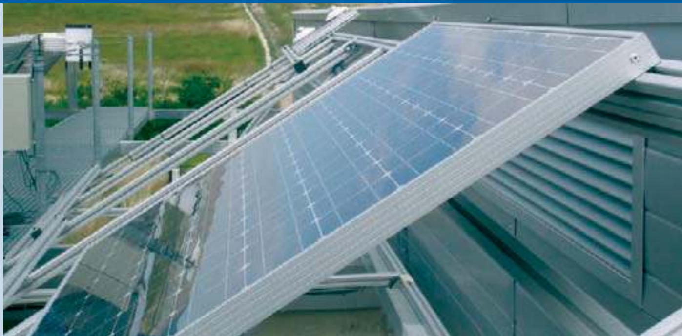
Fig. 1 - External exposure test for PV modules at CENER (Centro Nacional de Energías Renovables).
