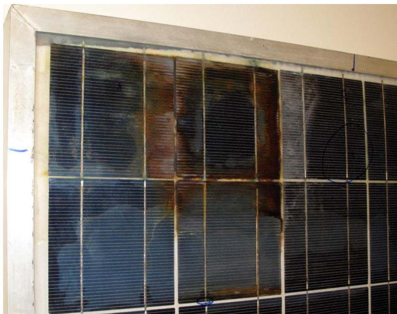
그림 4: 접착력이 부족한 것으로 입증된 특정 이오노머 봉지재를 사용한 유리/유리 모듈의 박리와 부식을 보여준다..
