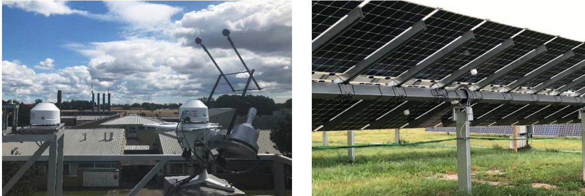
그림 27: (좌) 캠퍼스 Solar radiation monitoring 스테이션에서 측정된 법선면 직달, 수평면 확산과 글로벌 수평면 조사량. (우) 고정 경사 어레이 T11 의 후면에 설치된 등급 C 일사량계.
