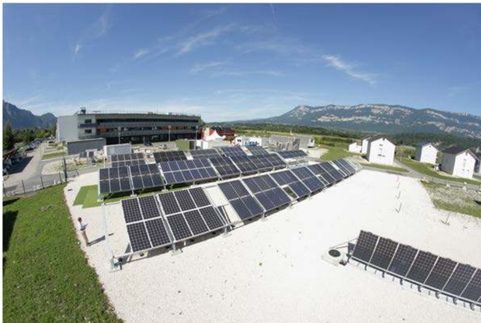
그림 69: INES 양면형 태양광 필드 테스트 사이트.
