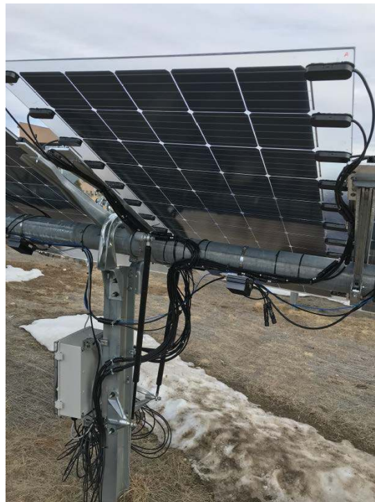
그림 15: NREL 양면형 필드의 중간에 장착된 12 개의 개별적 주소 지정 가능한 스트링을 가진 Custom 모듈.
