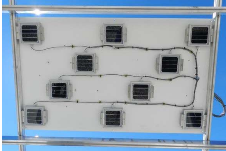
그림 20: 10 개의 기준 셀의 위치를 보여주는 Sandia IDM 의 후면.
