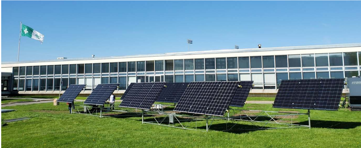
그림 77: ASPIRE 프로젝트 이전에 University of Ottawa SUNLAB 필드 시험장에 설치된 3 개의 Savanna 트랙커 중의 2 대.
