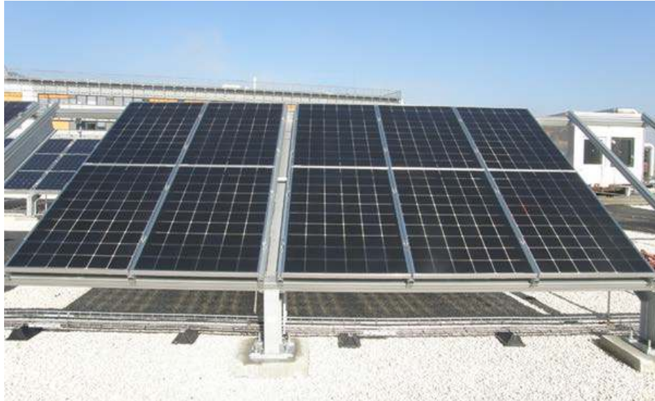
그림 70: INES 사이트에서 시험 중인 있는 양면형 모듈의 전면.
