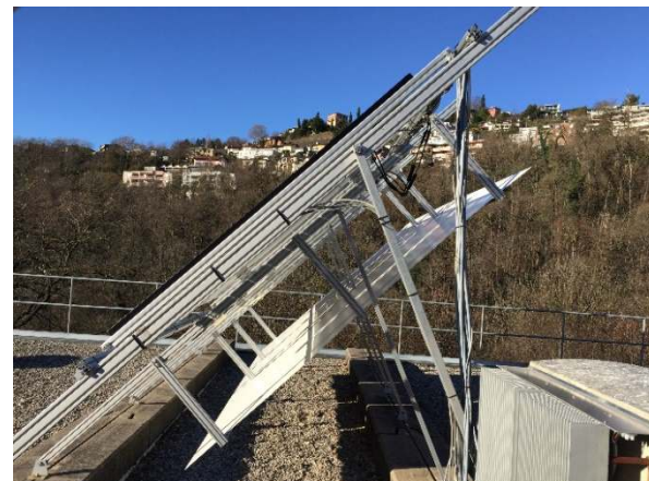
그림 8: (위) 스위스 프로젝트 ENHANCE 의 틀 내에서 SUSPI 에 설치된 양면형 시험 스탠드. 오픈 랙에 설치된 3 개의 모니터링용 양면형 모듈, 2 개의 더미 모듈과 1 개의 기준 단면형 모듈의 배치. (아래) 양면형 모듈 뒤에 장착된 백색 반사체의 전면과 측면.
