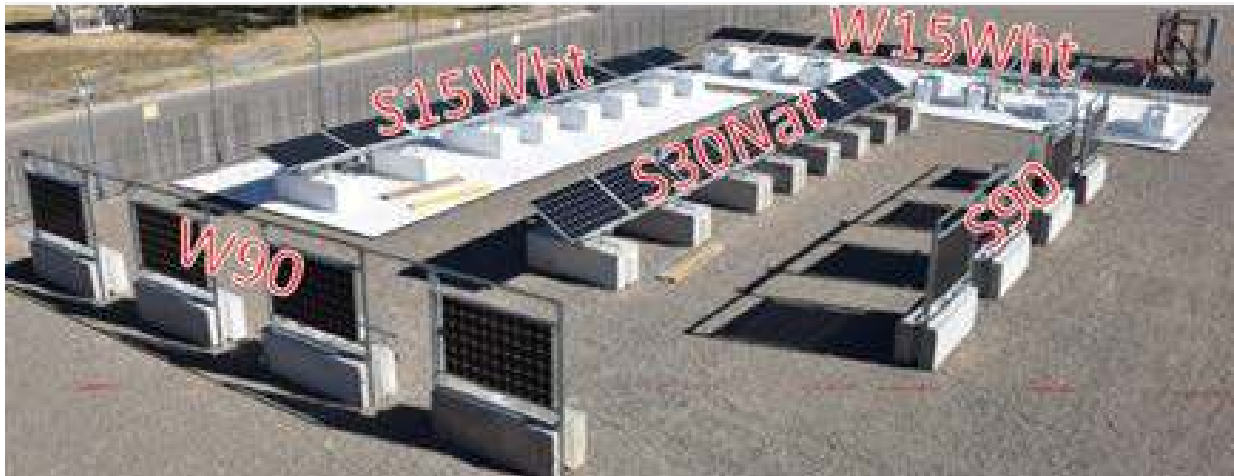
그림 65: 미국 New Mexico 주 Albuquerque SNL 에 있는 Prism Solar 양면형 테스트 어레이.
