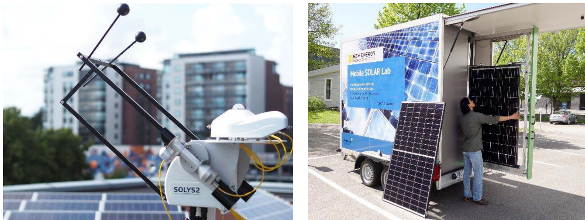
그림 36: (좌) 수평면 확산 조사강도 (DHI), 법선면 직달 조사강도 (DNI), 장착된 트랙커의 남쪽을 포함하는 태양광 조사강도 모니터링. (우) 모듈은 AAA+ 모바일 솔라 시뮬레이터로 특성을 분석한다.
