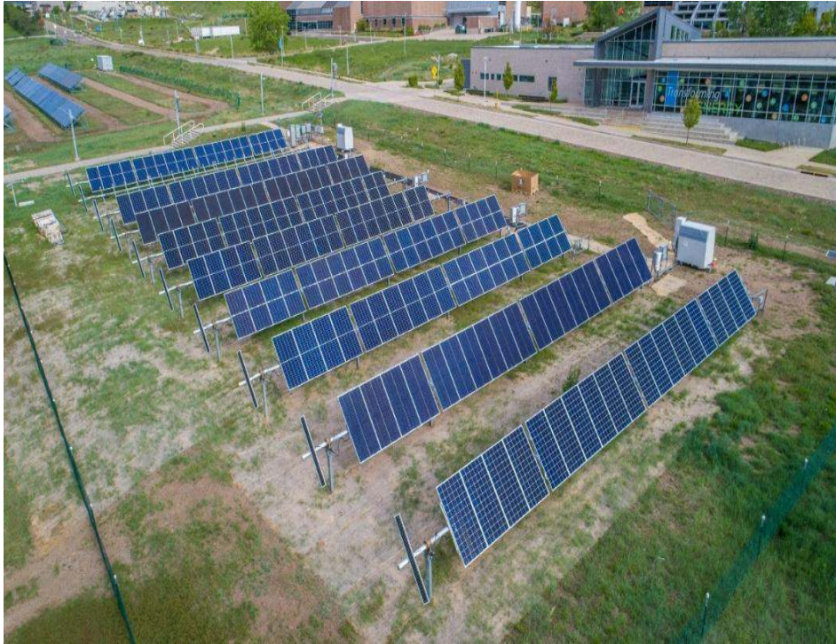
그림 12: 단일-축 트래커 테스트베드 (NREL 양면형 모듈과 시스템 성능 모니터링 프로젝트).
