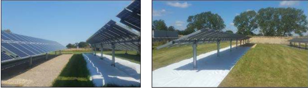
그림 25: 고정 경사 스트링에 대한 지면 커버(알베도) 실험(좌)과 HSAT 스트링에 대한 등가 실험(우).
