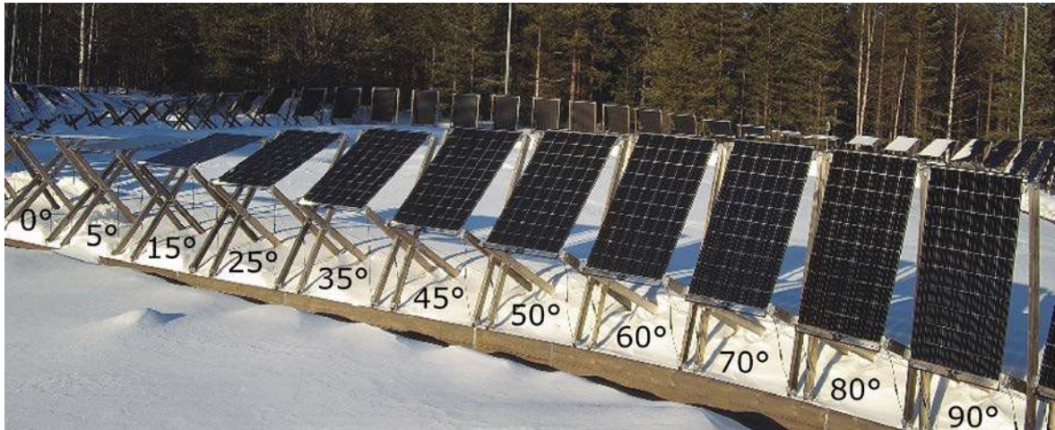
그림 21: Solvåg 에서의 선택된 섹션의 사진. 각 모듈의 아래에 경사각이 표시되어 있다.
