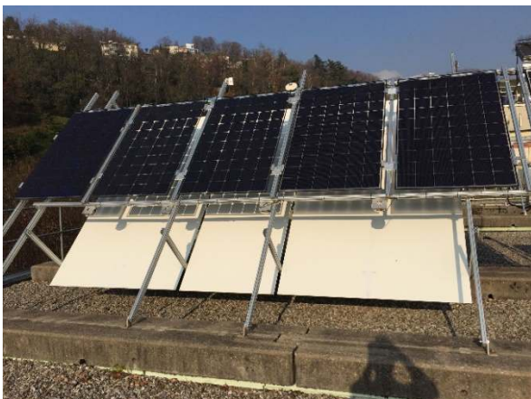
그림 8: (위) 스위스 프로젝트 ENHANCE 의 틀 내에서 SUSPI 에 설치된 양면형 시험 스탠드. 오픈 랙에 설치된 3 개의 모니터링용 양면형 모듈, 2 개의 더미 모듈과 1 개의 기준 단면형 모듈의 배치. (아래) 양면형 모듈 뒤에 장착된 백색 반사체의 전면과 측면.
